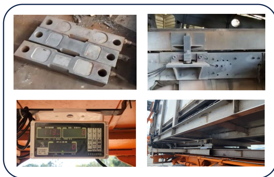
圖 8 施肥機具之感測裝置裝設狀況
