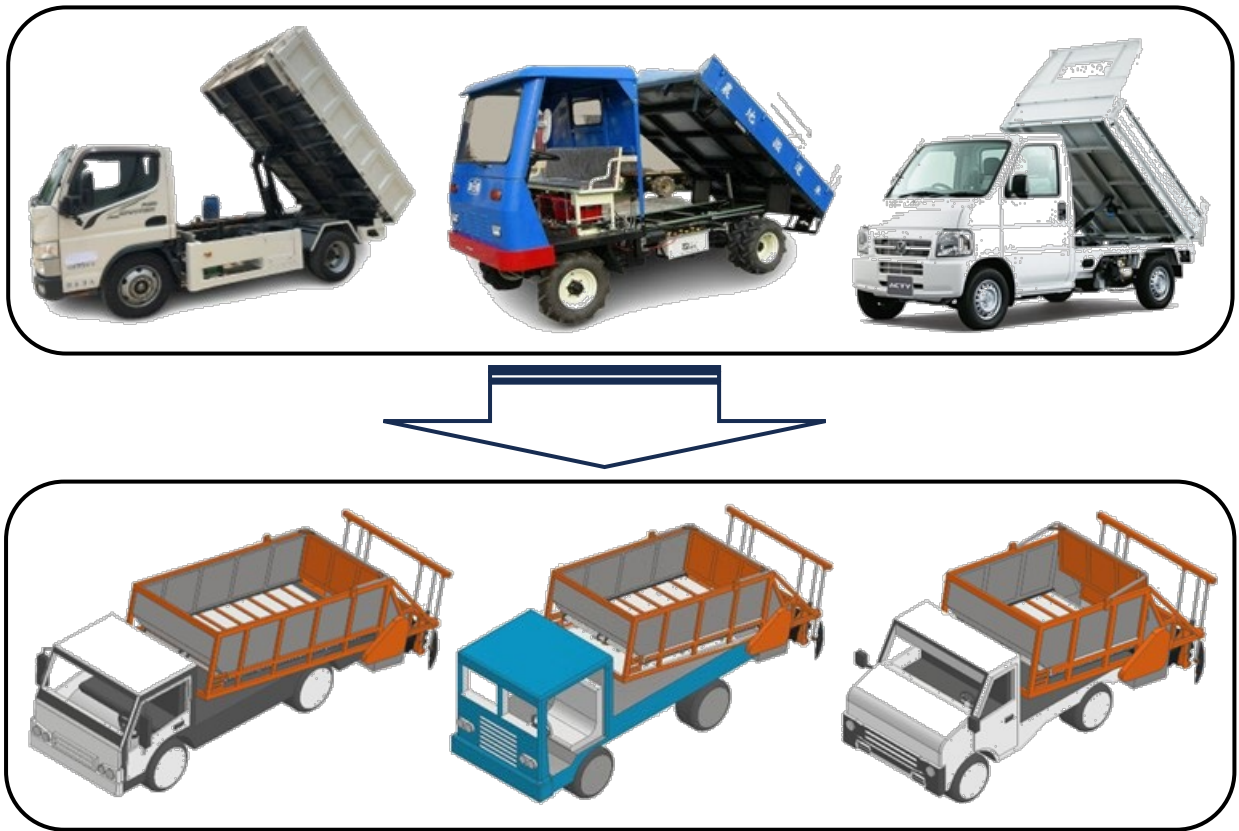
圖 3 田間施肥機械之模組化設計示意圖
