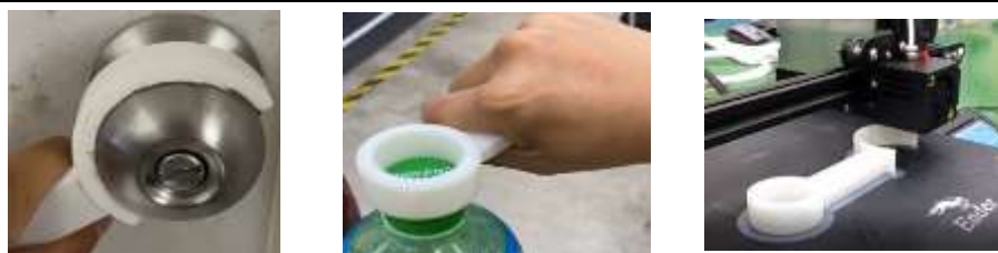
圖 32、開罐開門輔具設計與列印
