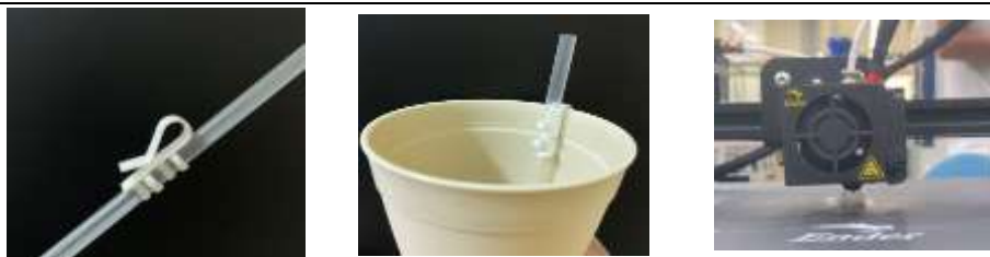
圖 38、吸管固定器設計與列印
